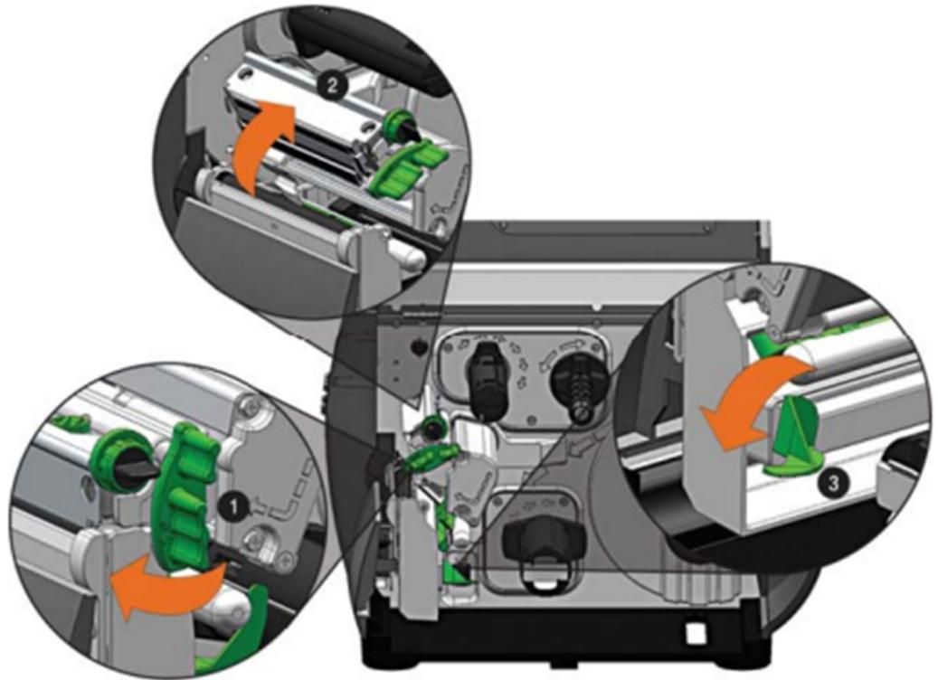
3. Ouvrez le couvercle des supports. Tournez et déverrouillez le loquet de la tête d'impression, puis relevez l'ensemble de la tête d'impression.
