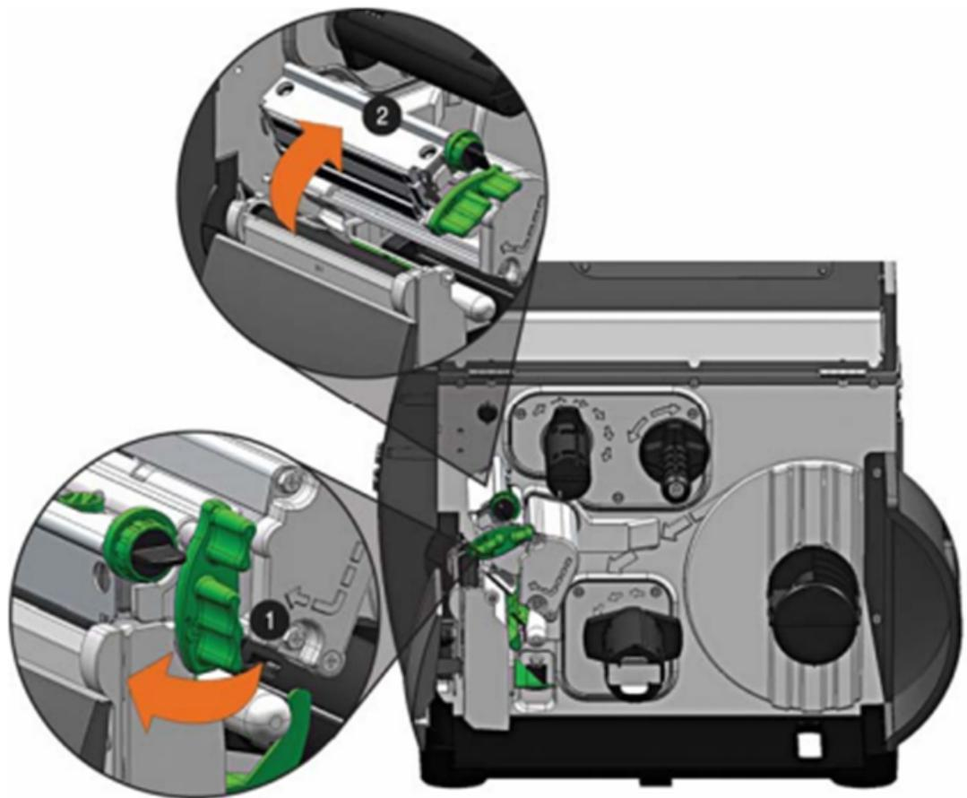
2. Faites glisser le rouleau de ruban sur le moyeu de distribution du ruban jusqu'à ce qu'il repose contre la bride. Assurez-vous que le ruban se déroule dans la bonne direction (voir le routage du ruban). Les illustrations ci-dessous montrent l'orientation correcte.
