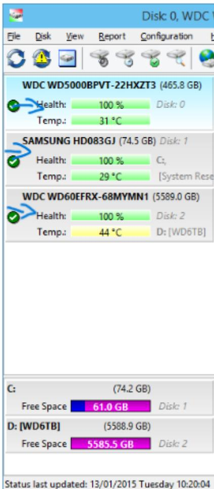
3. Le SMART est une technologie de surveillance intégrée au disque dur qui permet de détecter et signaler les problèmes potentiels de manière proactive.
